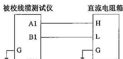
图 6 线缆直流电阻校准接线图
